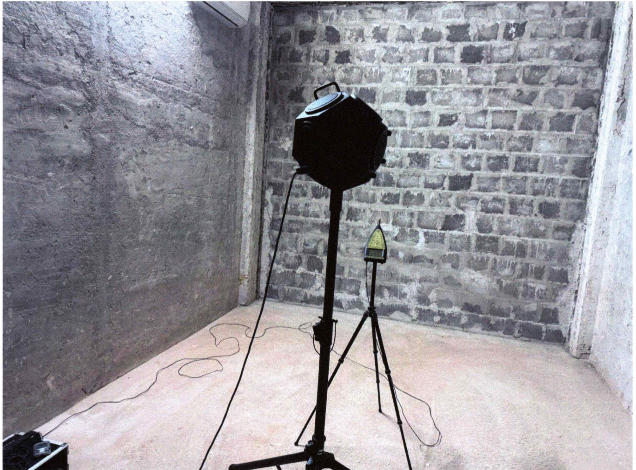
Fig. 1. Montaj perete în deschiderea pentru încercare, în camera de emisie (conform cerințelor din SR EN ISO 10140-2 și SR EN ISO 10140-5)
